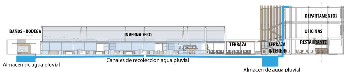
**Imagen 33.** Funcionamiento de recolección de Agua Pluvial. Fuente: elaboración propia
